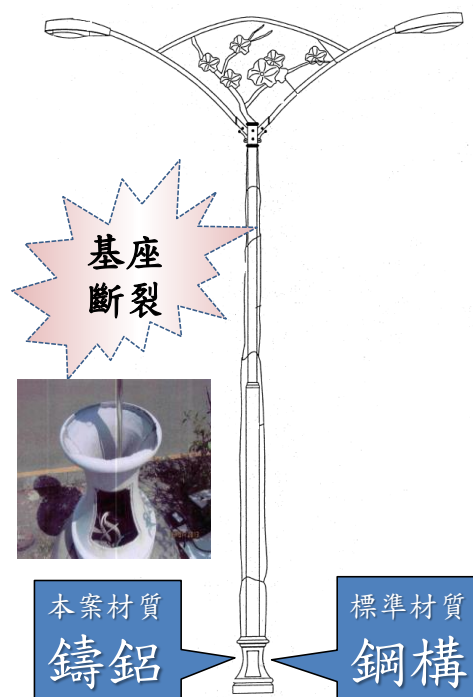
圖 11 造型路燈基座材質及破壞情形圖
