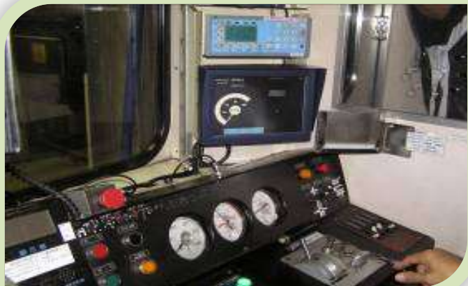
列車自動防護系統車上設備操作面盤
