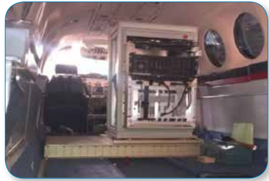
機載合成孔徑雷達 (SAR) 系統安裝情形
