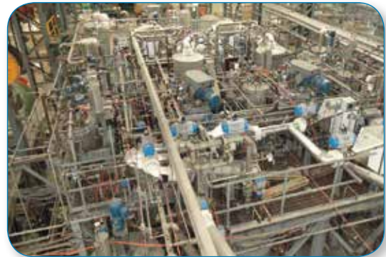
廢粒狀離子交換樹脂濕式氧化暨高效率固化系統設備假組裝情形
