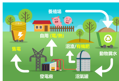
圖 15 沼氣發電流程
