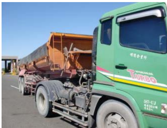
永康焚化廠底渣清運情形 (臺南市政府環境保護局提供)
