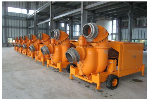
移動式抽水機 (臺南市政府水利局提供)
