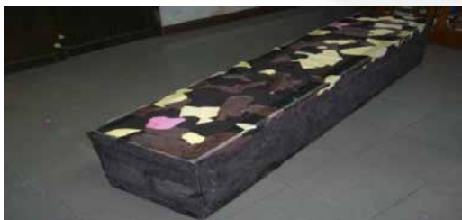
圖 20 再生 PE 發泡改良浮具
