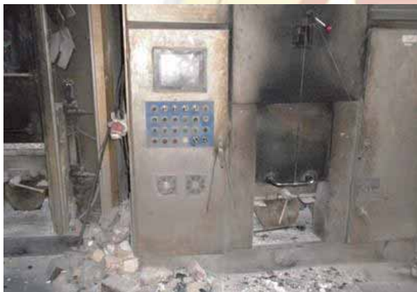
圖3 第一殯儀館火化爐耐火磚散落
