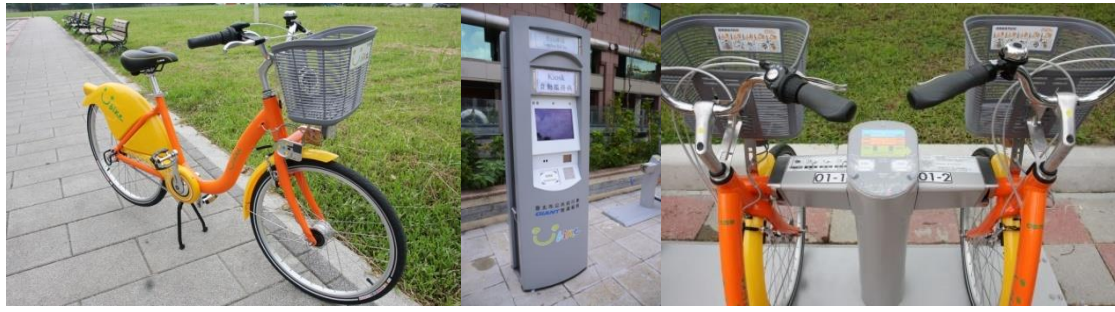
公共自行車設備：YouBike 車輛本體；導引式自動服務設備(Kiosk)；租賃站(每車柱設置 2 車位)。 資料來源：臺北市政府交通局提供。
