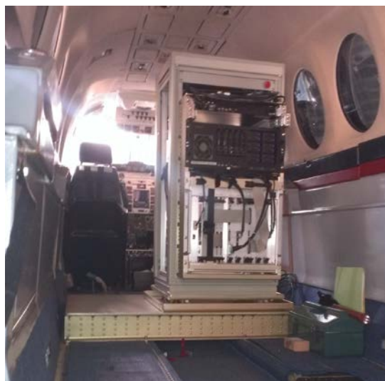
裝設於飛機內之 SAR 系統照片 (農航所提供)
