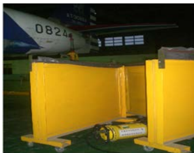
以X光機執行照相檢測照片 (漢翔公司提供)
