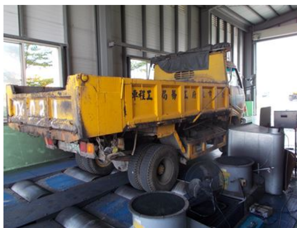
工務局柴油工程車接受排煙檢測 (臺南市政府環境保護局提供)
